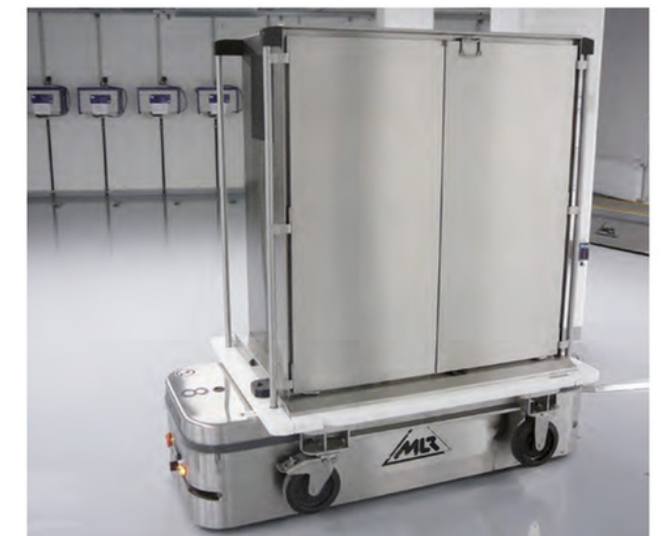
Chauffeurloos transportsysteem met Känguruh-systeem® transportwagens
